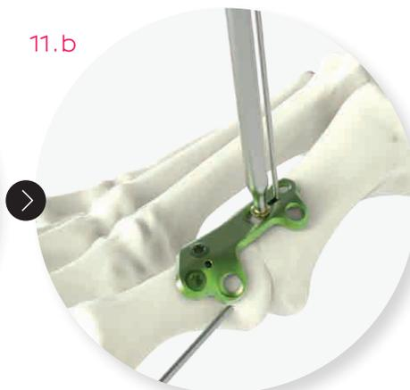
11.b) Insérer une vis non verrouillée Ø2.8 mm (RLT2.8Lxx) puis effectuer la compression à l'aide du tournevis (ANC575) (cf : § « Plot oblong à rampe »).
