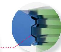
Le filetage sous tête de vis et le taraudage du plot de la plaque sont dotés des mêmes caractéristiques géométriques.
