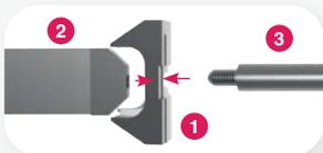
1. Insérer le guide de coupe - élément 1 (ANC014-1) (1) dans le guide de coupe - élément 2 (ANC014-2) (2), et visser l'ensemble sur la poignée (ANC024) (3).
